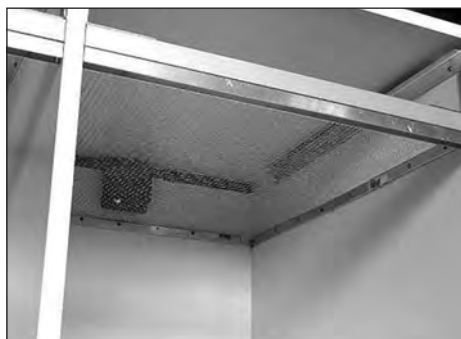
Figuur 5. De bovenkant van het terrarium met schuifrails voor de lichtbak, gemonteerde aluminium tussenbalk, schuifrails voor het glas, met aluminium stroken gemonteerd gaas én de aangebrachte ventilator in de achterwand. Picture 5. The upper part of the cage with sliding rails for the light-unit, aluminum beam, sliding rails for the windows, wire mesh and a ventilator in the back wall.
